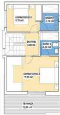
PLANTA PRIMERA SUPERFICIE CONST.-50.24m 2 TERRAZA.-10.95m 2
